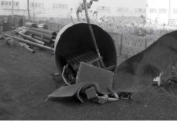
Boylerin patlayan/yırtılan bombe bölümü
