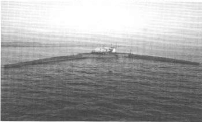
"Wave Dragon" olarak adlandırılan ikinci projenin bir prototipi Danimarka'nın kuzeyindeki bir fiyortta bulunmakta.
