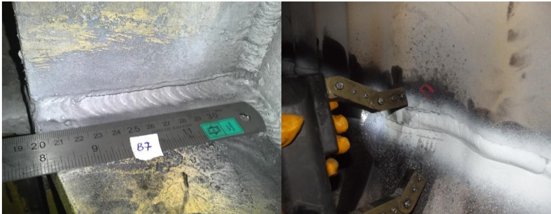
Şekil Periyodik Kontrol Esnasında Yapılan Tahribatsız Muayeneler
