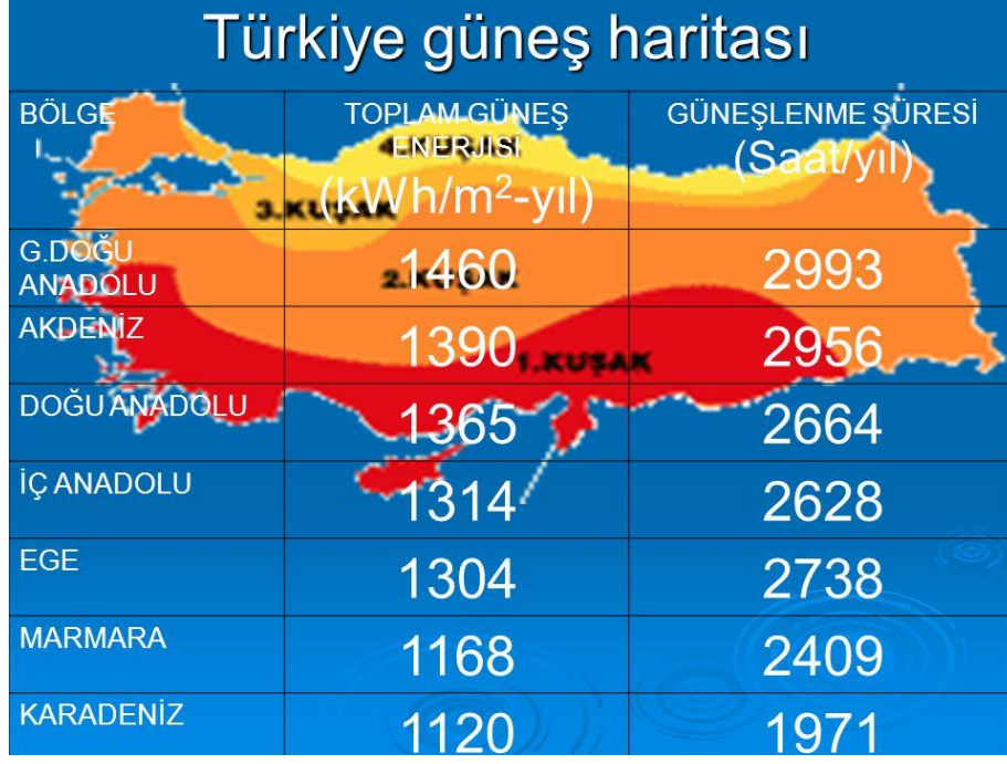
Şekil 2: Bölgelere Göre Güneş Radyasyon Değerleri ve Güneşlenme Süreleri
