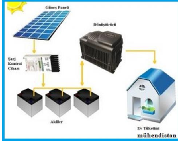
Şekil 4: Off-Grid Fotovoltaik Sistem Şeması
