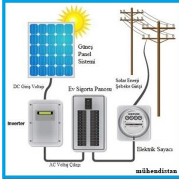
Şekil 5: On-Grid Fotovoltaik Sistem Şeması
