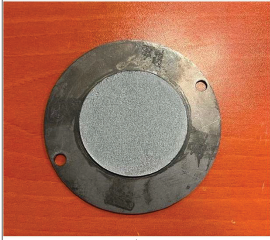
Şekil 1. Aşınma Deneyi İçin Epoksi Kaplanmış Disk Numuneleri
