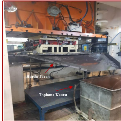
Şekil 7. İyileştirilmiş İş İstasyonu
